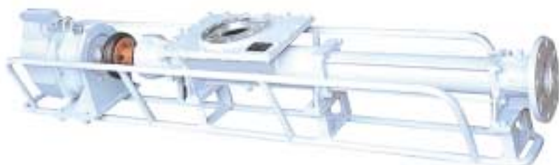
原油タンク内のスラッジ排出用 HNFA-402L 10PSエアモータ駆動 アルミ合金製 可搬式
