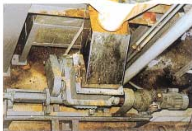
4段型高圧ポンプ HNFA-204B 圧力2.0MPa
