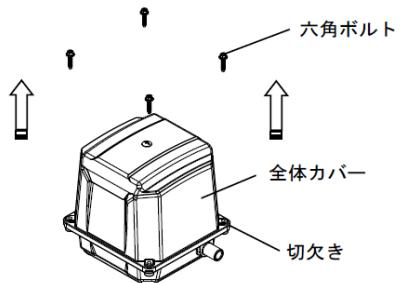
※ 全体カバーが外れにくい時は、切欠き部にマイナスドライバーを差し込み、こじ開けて外してください。
