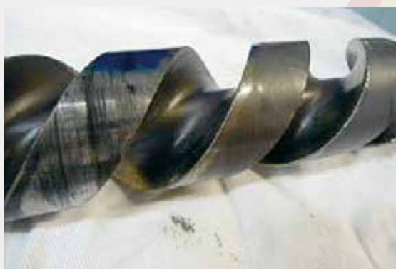
3軸ねじポンプ事故事例 ロータ損傷
